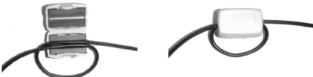
图 12 安装铁氧体滤波器
